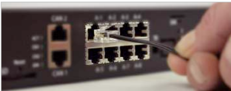
Abb.: Plug `n` Play Montage der intelligenten Didactum Sensoren. Per Autoidentifikation wird der Sensor sofort erkannt. Jeder Sensor besitzt ein SNMP OID.
